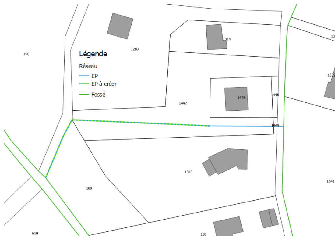
Figure 16: Implantation hypothétique du réseau d'assainissement pluvial pour le scénario 2
