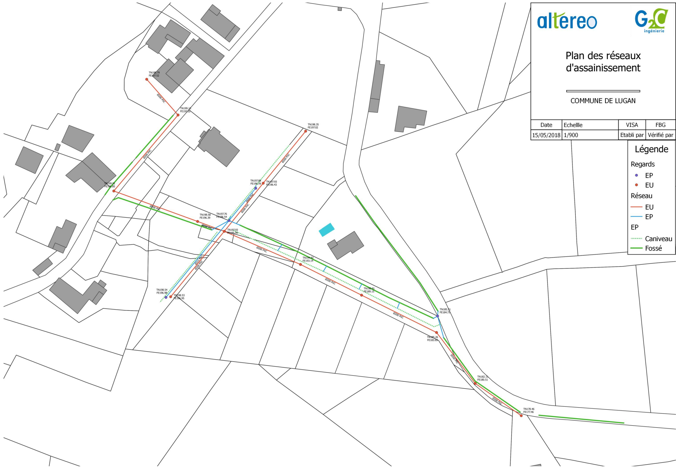
Figure 4: Plan des réseaux d'assainissement de Lugan
